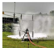
Figura 3.5 Misurazione delle correnti di dispersione, estinzione con schiuma e impostazione del getto a spruzzo (Sepanski et al., 2015)
